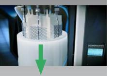
Die feinen, im Wasser schwebenden Kalkpartikel werden während den automatischen, zyklischen Ablassoperationen ausgespült.
