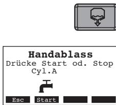
Um eine manuelle Abschlämmung durchzuführen:
