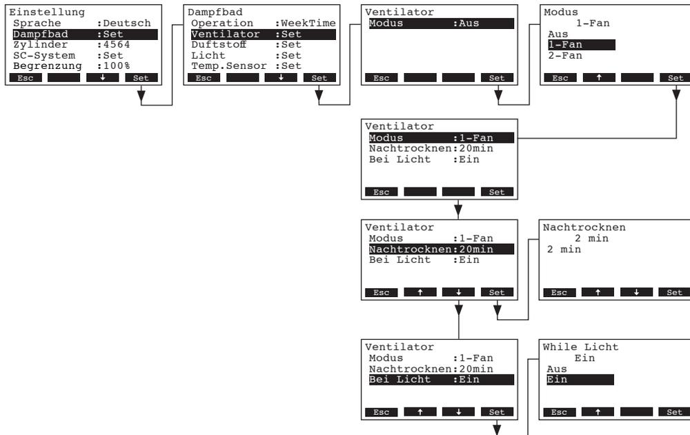
Legen Sie die Einstellungen für den Betrieb mit einem 3-stufigen Abluftventilator wie folgt fest:
